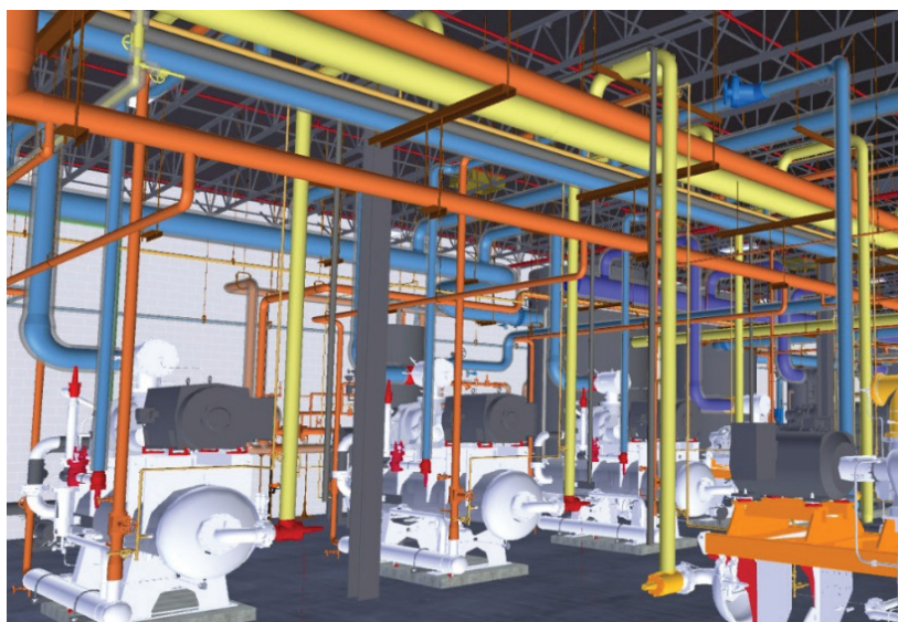
Рисунок 1 – Віртуальне проєктування промислового холодильного обладнання за допомогою Building Information Modeling
