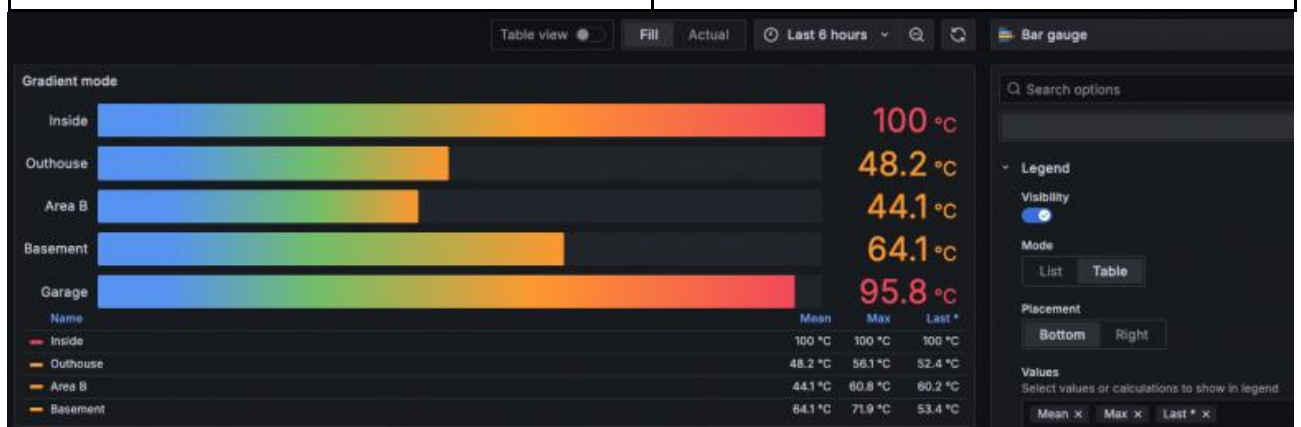
Рис. 3.15 Приклад інтерфейсу моніторингу температури в приміщеннях
