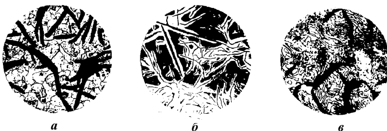
Рис. 1.4. Структури сірого чавуну з феритною (а), ферито-перлітною (б), перлітною (в) основами; \times 200
