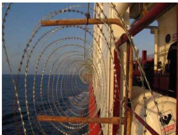
Рис. 3.56. Використання дротових і сіткових загороджень для захисту суден
