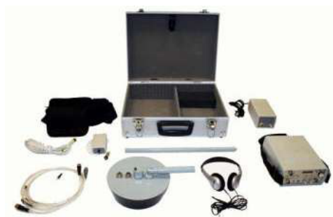
Рис. 3.7. Переносні комплекси виявлення ВР: а – детектор пари ВР "Шельф-ПКЛ"; б – переносний комплекс виявлення ВР у багажі і транспортних упаковках "ШЕЛЕСПЕР"
