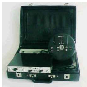
Рис. 3.7. Переносні комплекси виявлення ВР: а – детектор пари ВР "Шельф-ПКЛ"; б – переносний комплекс виявлення ВР у багажі і транспортних упаковках "ШЕЛЕСПЕР"
