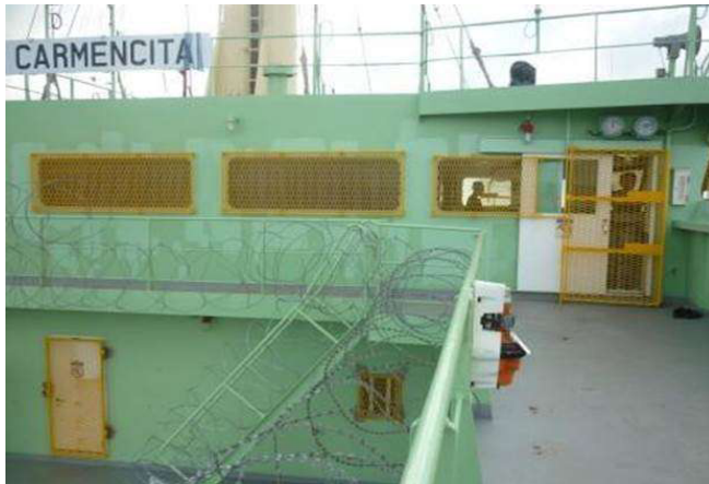
Рис. 3.57. Використання колючого дроту для блокування трапів
