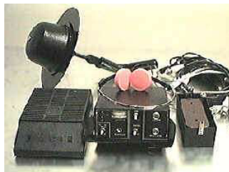
Рис. 3.8. Прилади нелінійної локації: а – "Октава-3М"; б – "Обь-АЛ"; в – "Онега"
