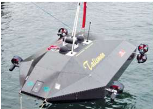
Рис. 3.73. Загальний вигляд НПА "Talisman"
