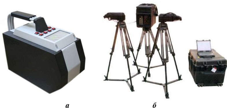
Рис. 3.7. Переносні комплекси виявлення ВР: а – детектор пари ВР "Шельф-ПКЛ"; б – переносний комплекс виявлення ВР у багажі і транспортних упаковках "ШЕЛЕСПЕР"
