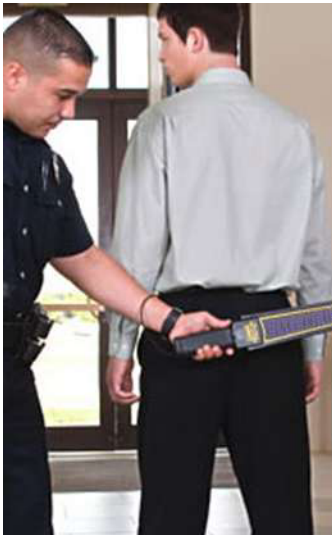
Рис. 3.9. Зовнішній вигляд (а) та застосування (б) металошукача АКА-7202-М
