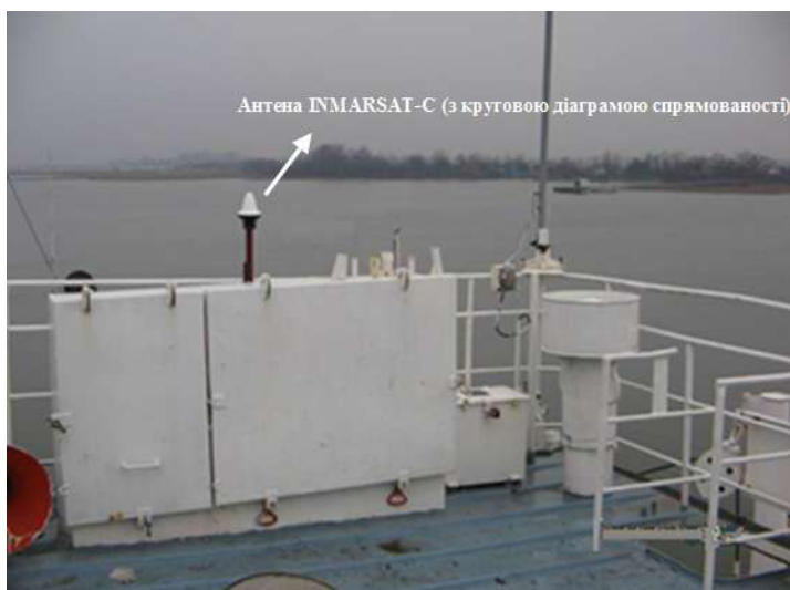
Рис. 3.19. Судновий термінал ІНМАРСАТ-С "SAILOR-4000" в стійці ГМСЗБ ( а ) та антена "ІНМАРСАТ-С" з круговою діаграмою спрямованості ( б )
