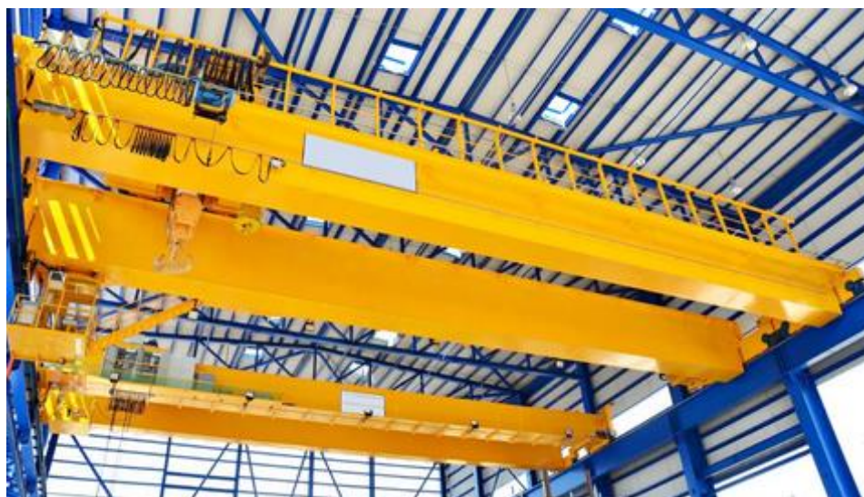
Рисунок 1 – Зовнішній вигляд мостового двобалочного крана
