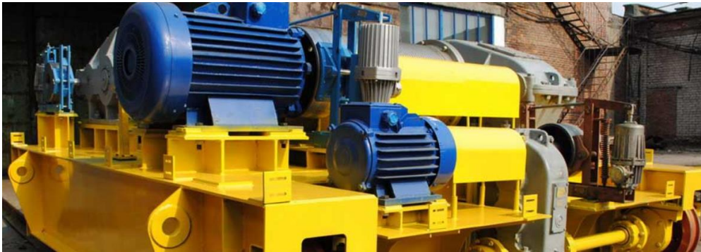
Рисунок 2 – Зовнішній вигляд механізму пересування мостового крана
