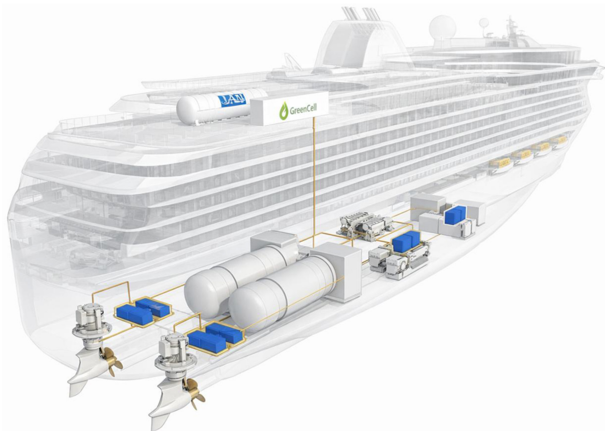
Рис. 2. Концептуальна архітектура енергетичної установки річного круїзного судна з інтегрованими танками рідкого водню та паливними елементами
