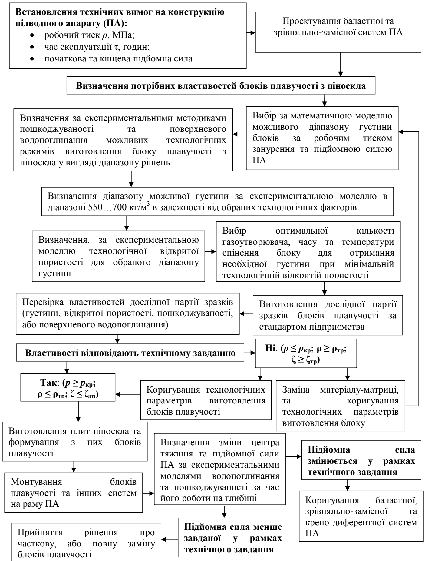
Рис.9. Схема методики проектування підводного апарату з урахуванням зменшення підйомної сили блоків плавучості з піноскла внаслідок накопичення експлуатаційних пошкоджень
