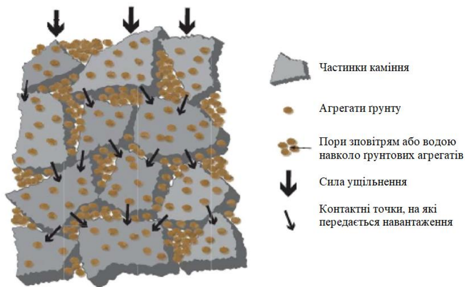
Рис. 3.5 Концептуальна діаграма структурного ґрунту
