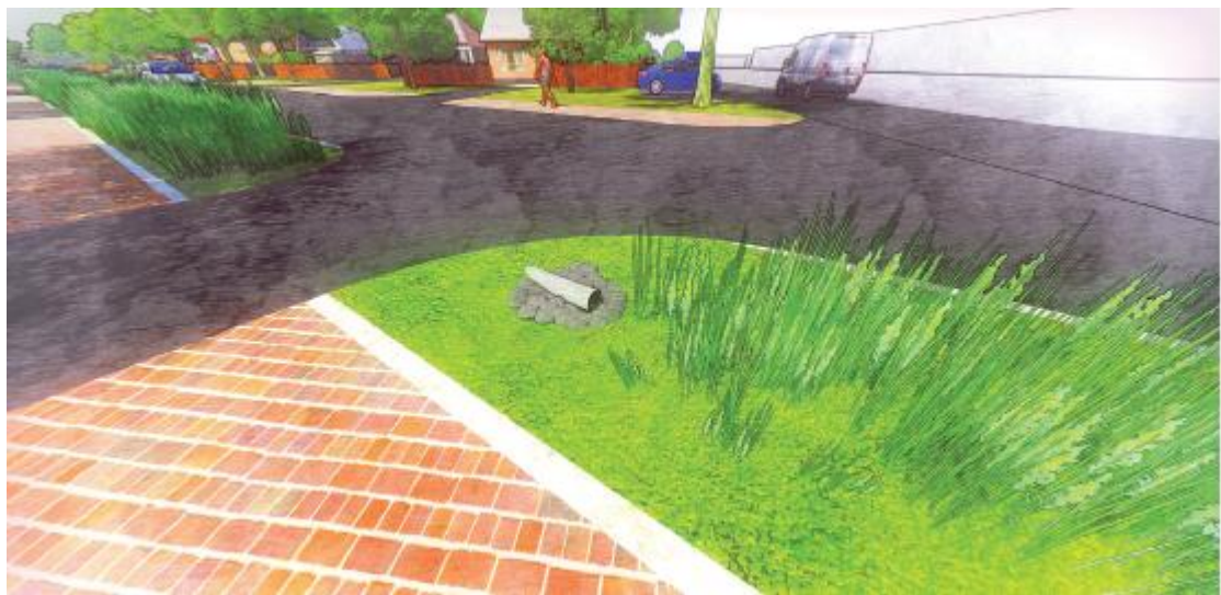
Рис. 5.25 Перспектива валу з підземним трубопроводом [64]
