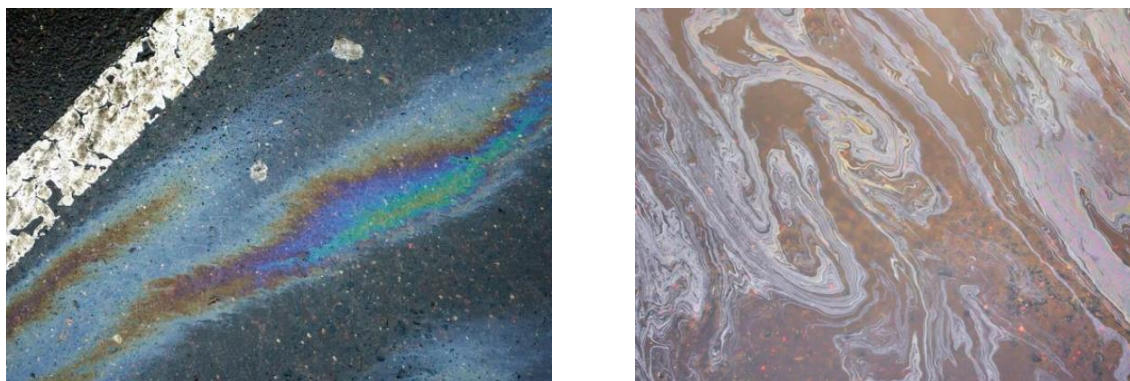
Рис. 1.3. Приклади локального розливу ПММ на асфальтове покриття
