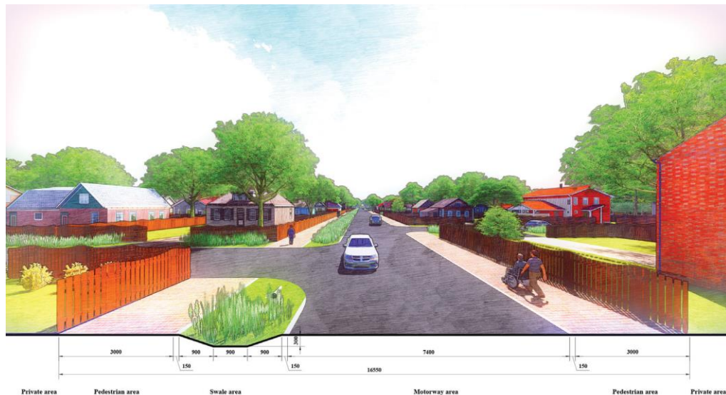
Рис. 5.23 Секція А-А для наскрізної дороги [64]
