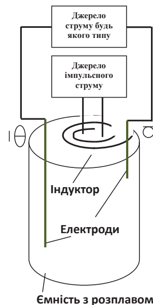
Рис. 3. Геометрична модель принципу КЕСО+МІО у рідкометалевому стані
