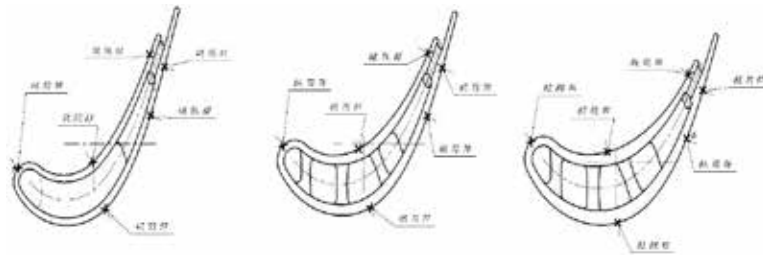
Рис. 2. Схема препарування профілю РЛ термопарами по металу
