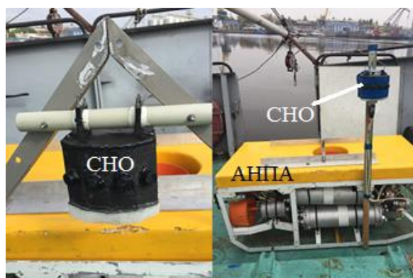
Рисунок 5.3 – Зовнішній вигляд СНО та її розташування на АНПА-1
