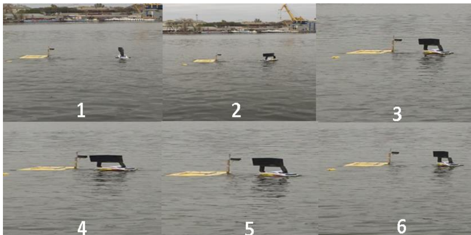
Рисунок 5.10 – Фотофрагменти морських натурних випробувань САК АНПА як «агента» групи: 1 – обидва макети АНПА відділені один від одного і рухаються з заданими швидкостями; 2 – макет АНПА-1 і макет АНПА-сусіда перебувають у зоні притягання, тому САК макетом АНПА-1 реалізує режим когезії (макет АНПА-1 наближається до макета АНПА-сусіда); 3 – макети АНПА розташовані занадто близько; 4 – макети розташовані у зоні небезпечного зближення; САК макета АНПА-1 змінює курс апарата на віддалення від макета АНПА-сусіда; 5 – макет АНПА-1 віддалився від макета АНПА-сусіда і режим адгезії виконано; 6 – безпечний режим, коли обидва макети почали вільно рухатись заданими курсами та швидкостями
