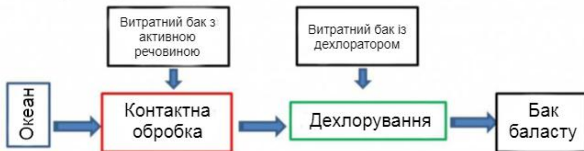
Рис. 2.4. Принципова схема системи управління баластними водами з хлоруванням
