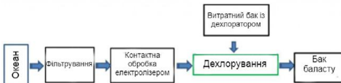
Рис. 2.5. Принципова схема установки обробки баластних вод, яка використовує гіпохлорит натрію, що виділяється з морської води
