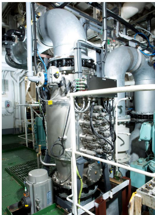
Рис. 3.11. Розміщення на борту судна в машинному відділенні системи управління баластними водами
