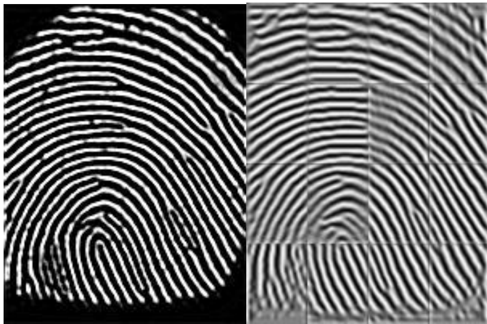
Рисунок 4.6 – Результат роботи фільтра Габора над перетвореним зображенням
