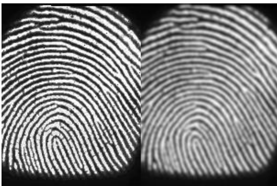
Рисунок 4.2 – Розмивання Гауса, застосоване до відбитку пальця
