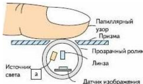
Рисунок 1.6 – Принцип дії роликового сканеру
