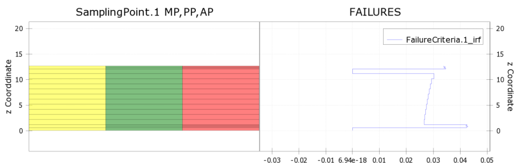
Рисунок 4.8 – Епюра розподілу напружень за критерієм Цай-Бу (фланець)
