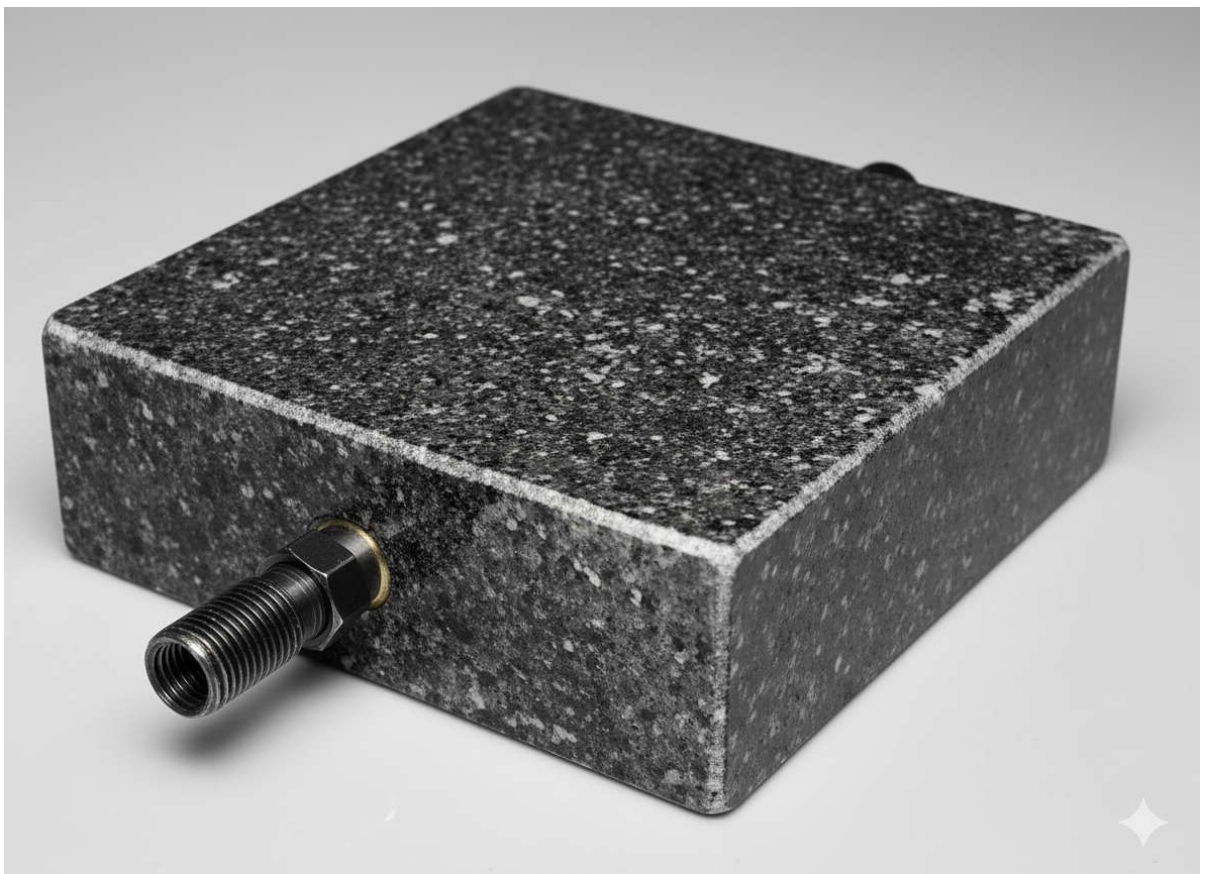
Рис. 1.2 – гранітна повірочна та розміточна плита
