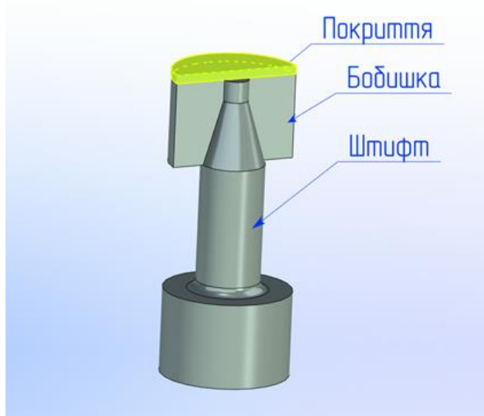
Рисунок 3.3 – Зразок для визначення міцності зчеплення покриттів з основою
