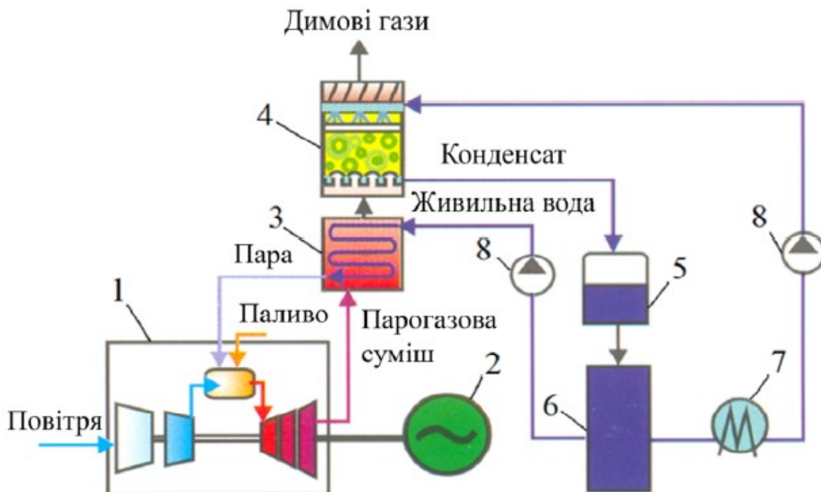
Рис. 1.14. Монарна парогазова установка (цикл «Водолій»:
