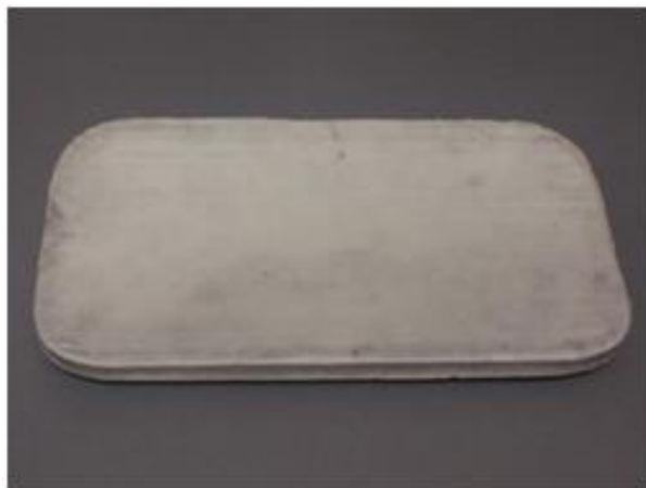
Рисунок 8.4 – Склоалюмінієва плитка 500×500 мм, \delta \geq 10 мм
