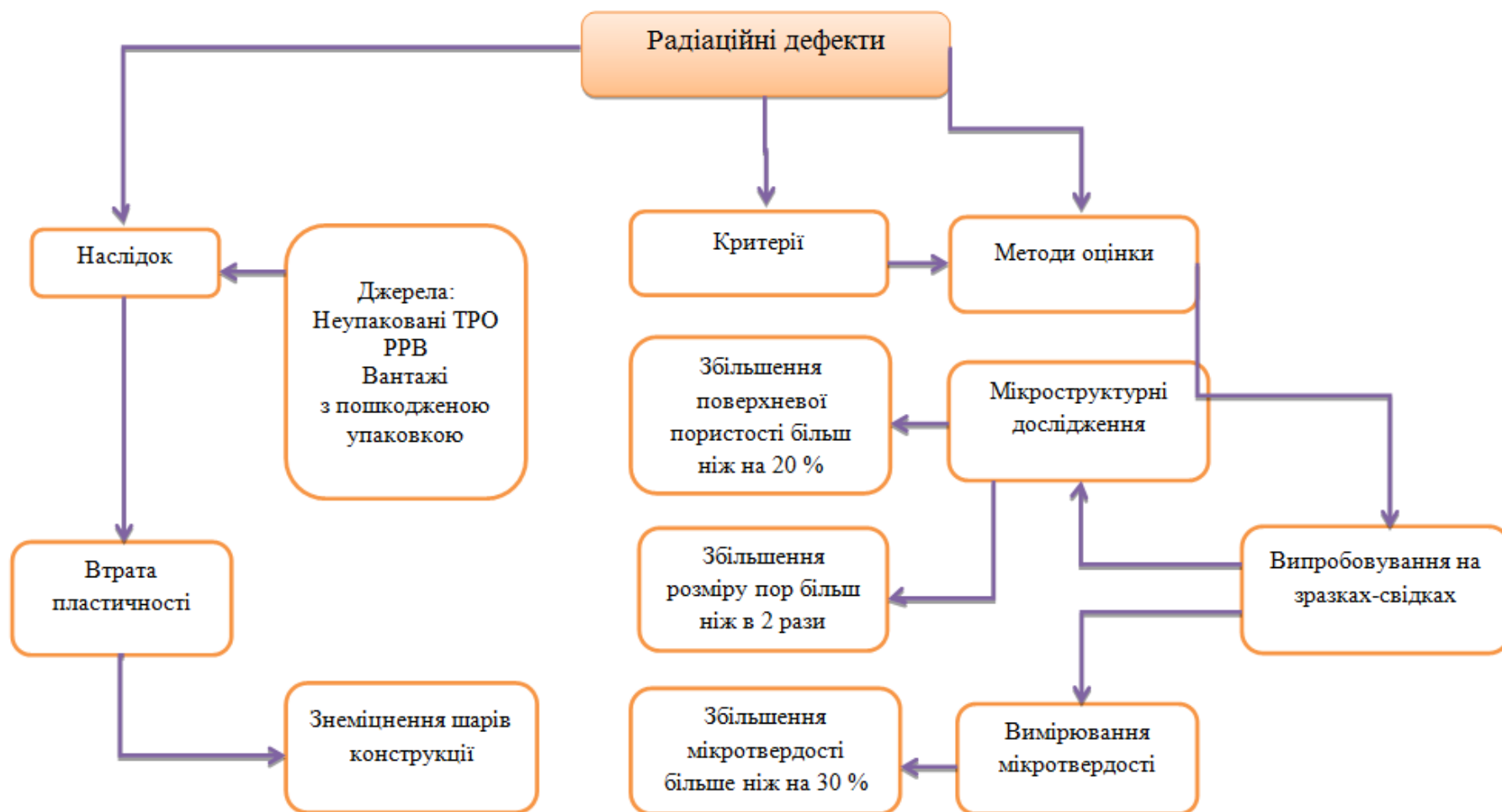
Рисунок 5.8 – Радіаційні дефекти метал-скляного захисного шару конструкцій
