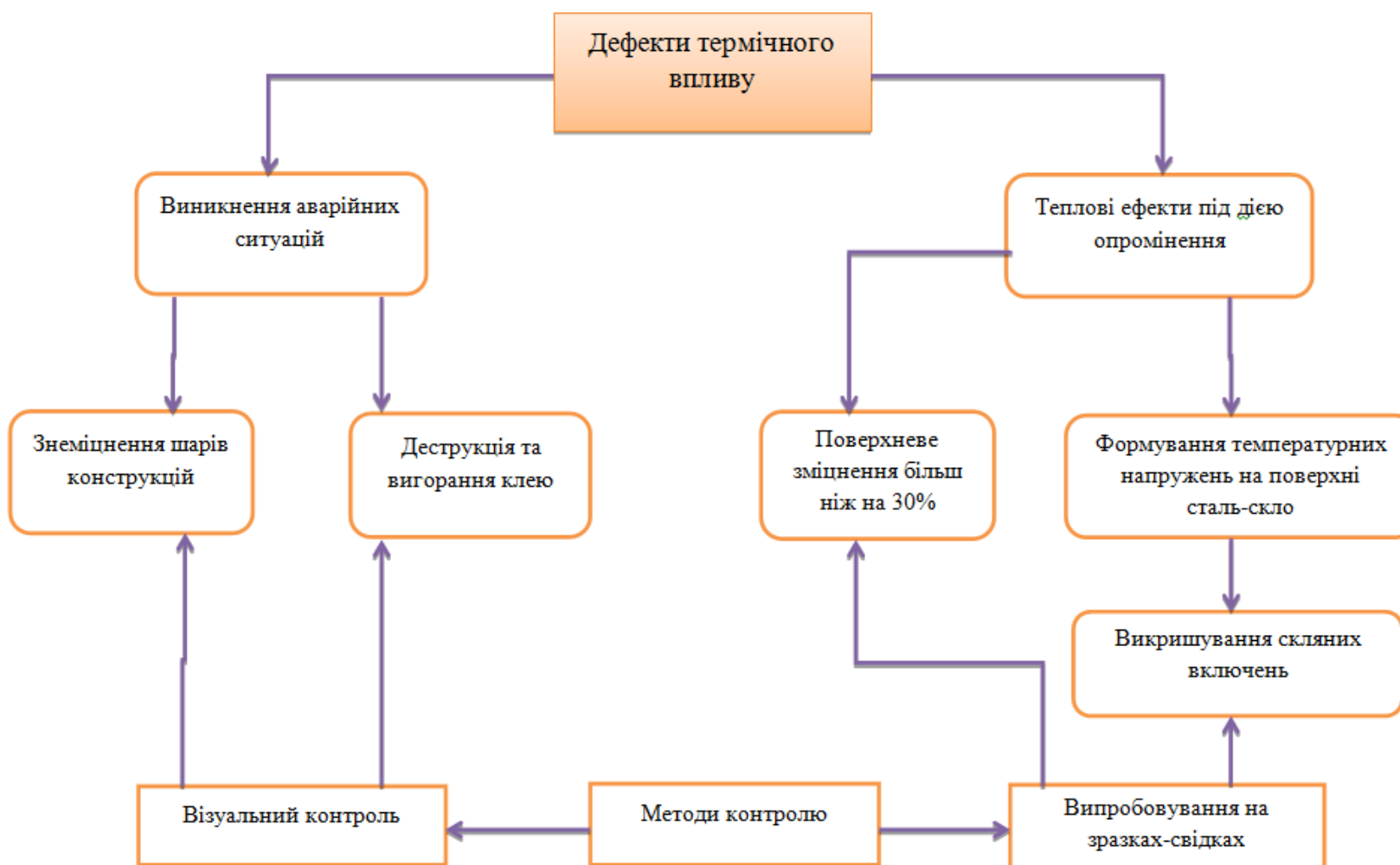
Рисунок 5.9 – Дефекти термічного впливу на метал-скляний захисний шар конструкцій
