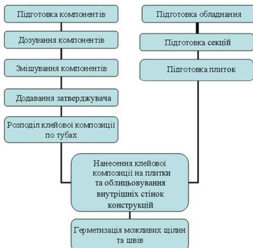
Рисунок 6.4 – Технологічна схема облицювання сталевих поверхонь панелі модуля біологічного захисту склоалюмінієвими плитками
