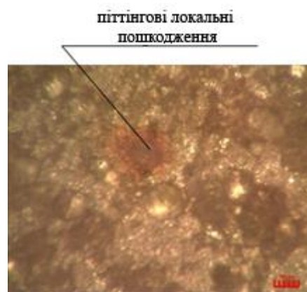
Рисунок 7.24 – Мікрофотографія ( \times 150 ) поверхні покриття після корозійних випробувань
