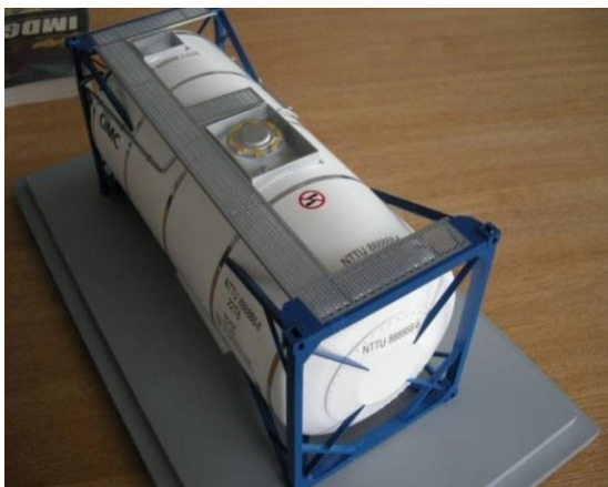
Рисунок 1.4 – Танк-цистерна типу ІМО-1 для рідких РАВ [51]
