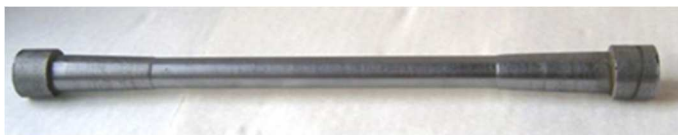
Рис.2.1 – Форма циліндричного зразку до випробувань на одновісне статичне розтягнення.
