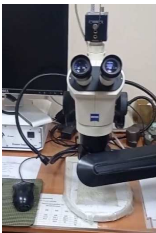
Рис. 2.6. Стереомікроскоп Carl Zeiss (Stemi 2000) для макроаналізу
