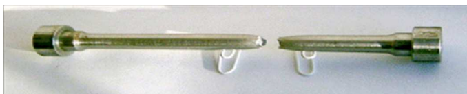
Рис.2.1 – Форма циліндричного зразку після випробувань на одновісне статичне розтягнення.
