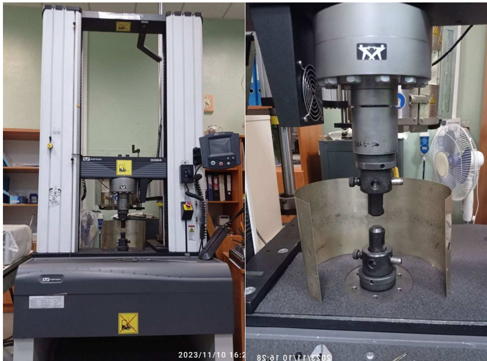
Рис. 2.3 – Стенд на одновісне статичне розтягнення при кімнатній та підвищеній температурі (система вимірювання параметрів досліджень Instron 3382).
