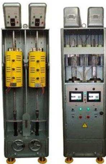
Рис 2.1 Машина для випробувань матеріалів на тривалу міцність та повзучість серії АИМА 5-1
