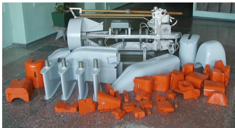
Рисунок 1.7 – Підводний апарат «Аргобуй» з закладними блоками плавучості зі сферопластика (на передньому плані) [13]
