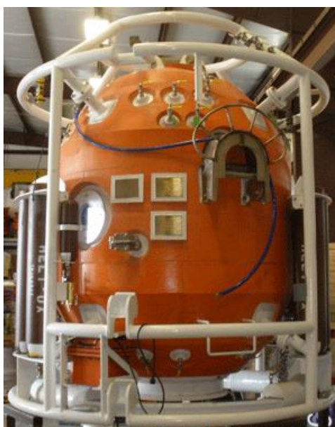
Рисунок 1.8 – Водолазний колокол компанії Trelleborg-offshore з теплоізолюючими блоками на основі пінополіуретану [50]
