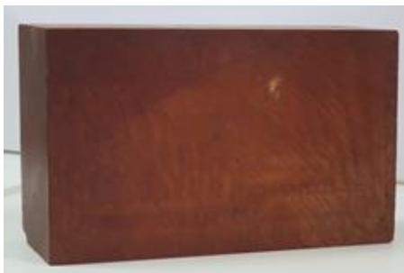
Рисунок 1.9 – Елемент блока плавучості зі сферопластика «Syntactic foam» [58]
