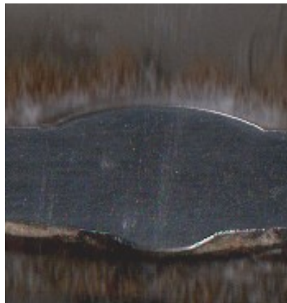
Рисунок 2.18 Макрошліф з'єднання 1.8. стикове з'єднання труби діаметру 108 мм.
