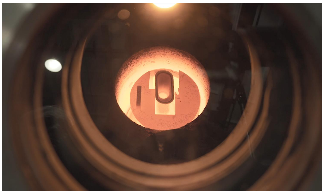
Рис.3.3 Заливка металу в модель у вакуумно – індукційній плавильній установці
