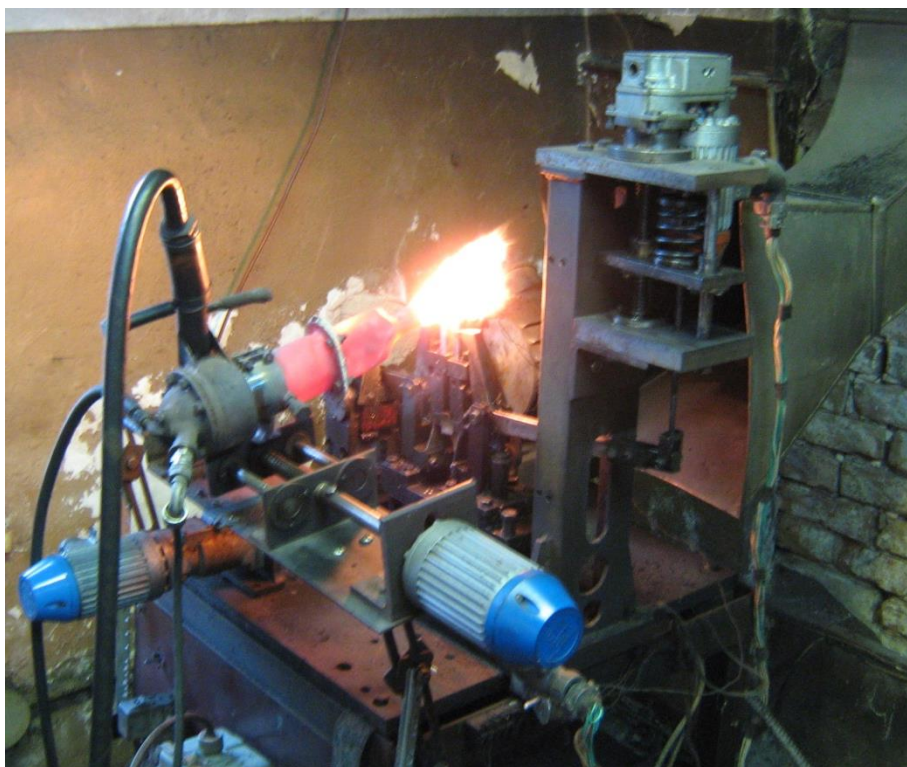
Рисунок 4.13 – Зовнішній вигляд установки та робоче положення пальника в процесі проведення випробувань.
