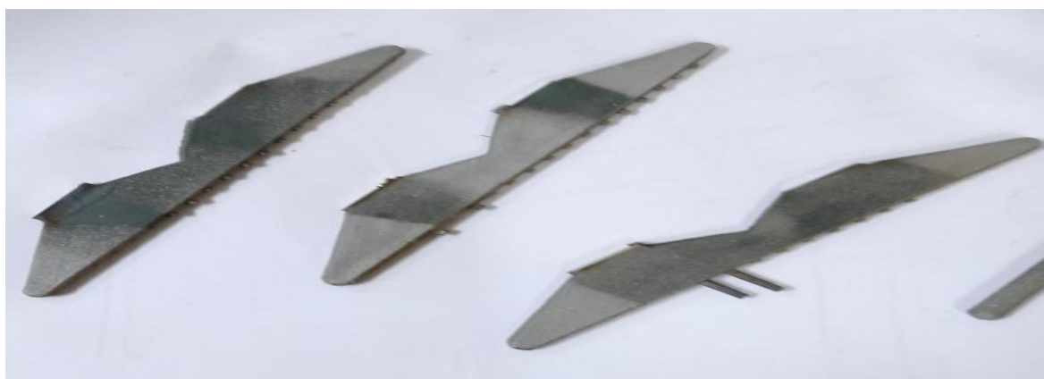
Рис. 3.6. Ливарний блок після обрубки та відрізки стеліту Х30Н50Ю5Т2
