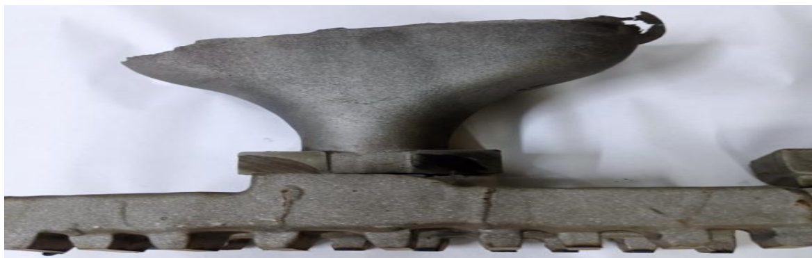
Рис. 3.6. Ливарний блок після обрубки та відрізки стеліту Х30Н50Ю5Т2
