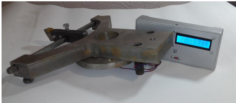
Рисунок 1 - Пристрій для вимірювання сили різання
