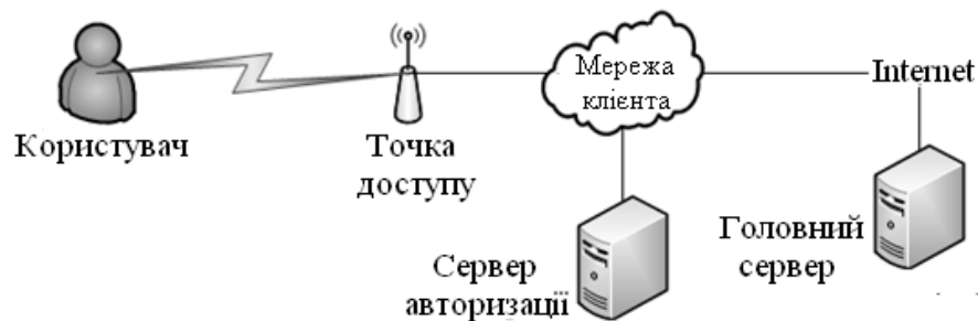
Рисунок 3.1 - Схема вузла оповіщення
