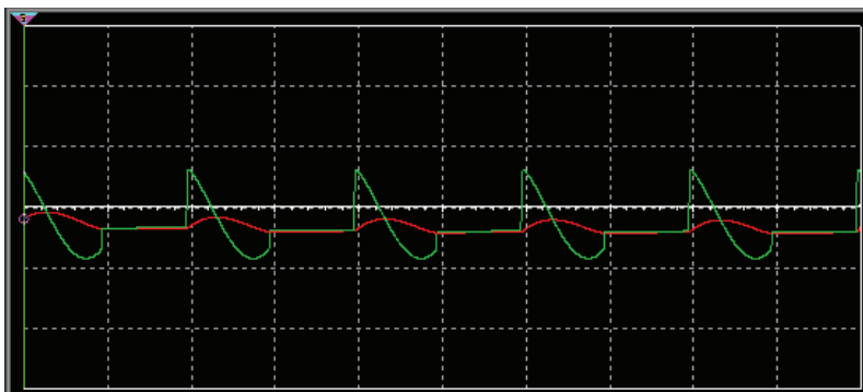
Рисунок 6 – \cos\varphi = 0,7 (кут 120^\circ ), потужність менше 0
