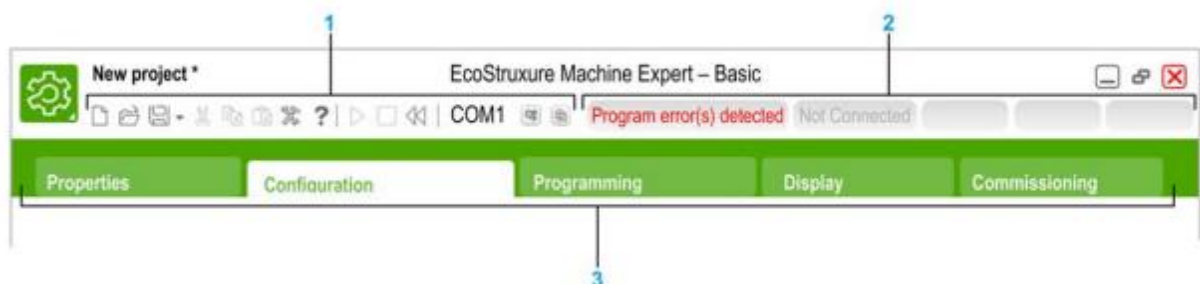
Рис. 3.1 – Панель інструментів, рядок стану та вкладки модулів у головному вікні програмного інтерфейсу:
