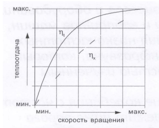
Рис. 4.6. Зміна тепловіддачі роторного регенеративного теплообмінника
