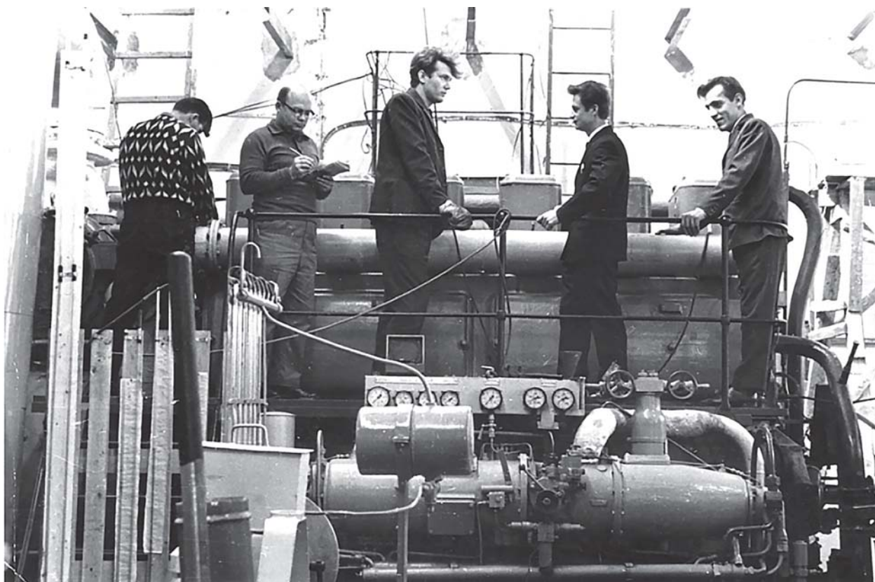
1975 р. Теплотехнічна лабораторія. Студенти-дизелісти проводять заключну лабораторну роботу з випробування двигуна Д50 потужністю 700 кВт під керівництвом доцента Шулежжа Ю. М. і старшого викладача Наливайка В. С.
