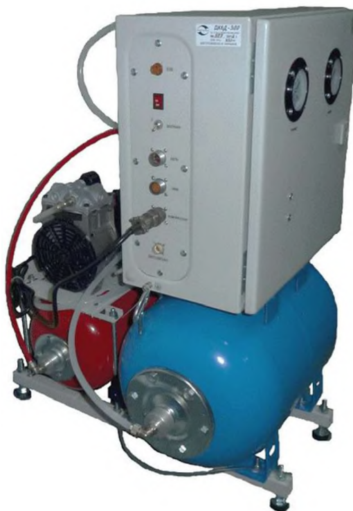
Рисунок 1.4 – Загальний вигляд кабельного дегідратора
