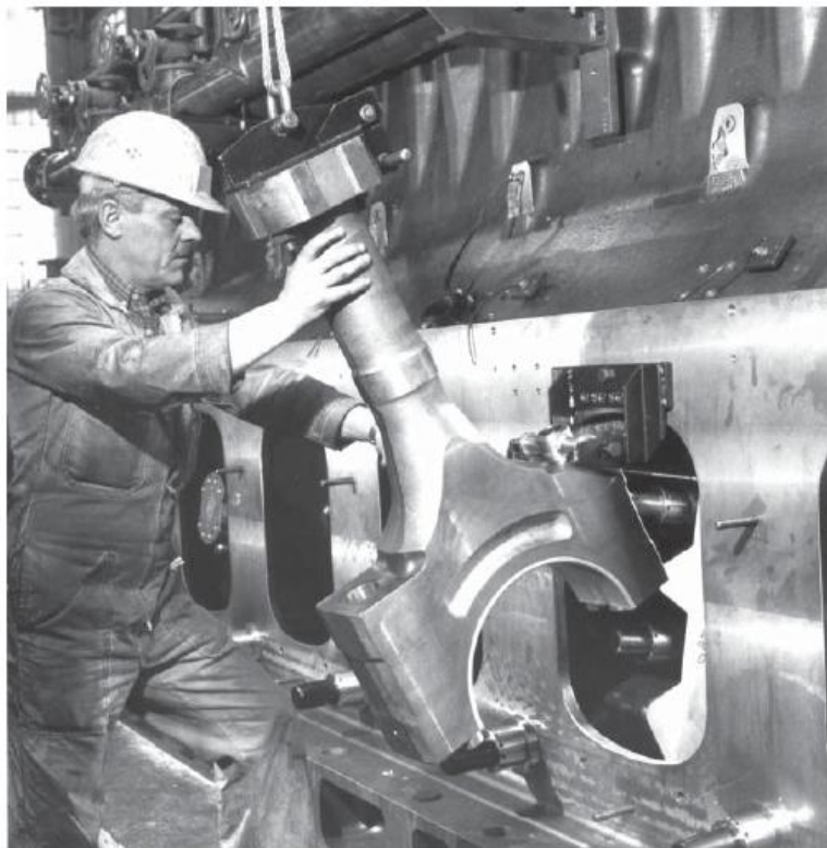
Рисунок 1.5 – Демонтаж шатуна дизеля 6ЧН 40/54 (MAN 6L40/54)
