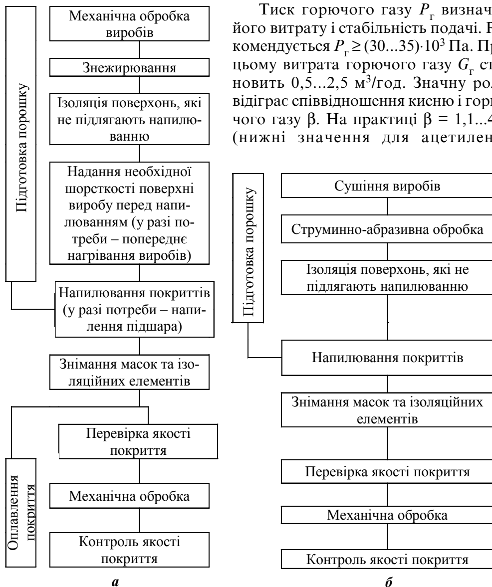
Рис. 4.2. Технологічна схема отримання покриттів газополуменовим методом: а – для металевих виробів; б – для виробів з неметалевих матеріалів
