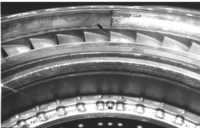
Рис. 11.8. Експериментальна (ліва) і серійна вставки після випробування на газотурбінному двигуні
