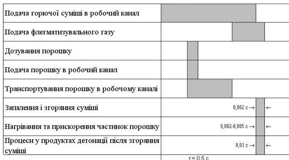
Рис. 7.2. Послідовність операцій в разі детонаційного напилення
