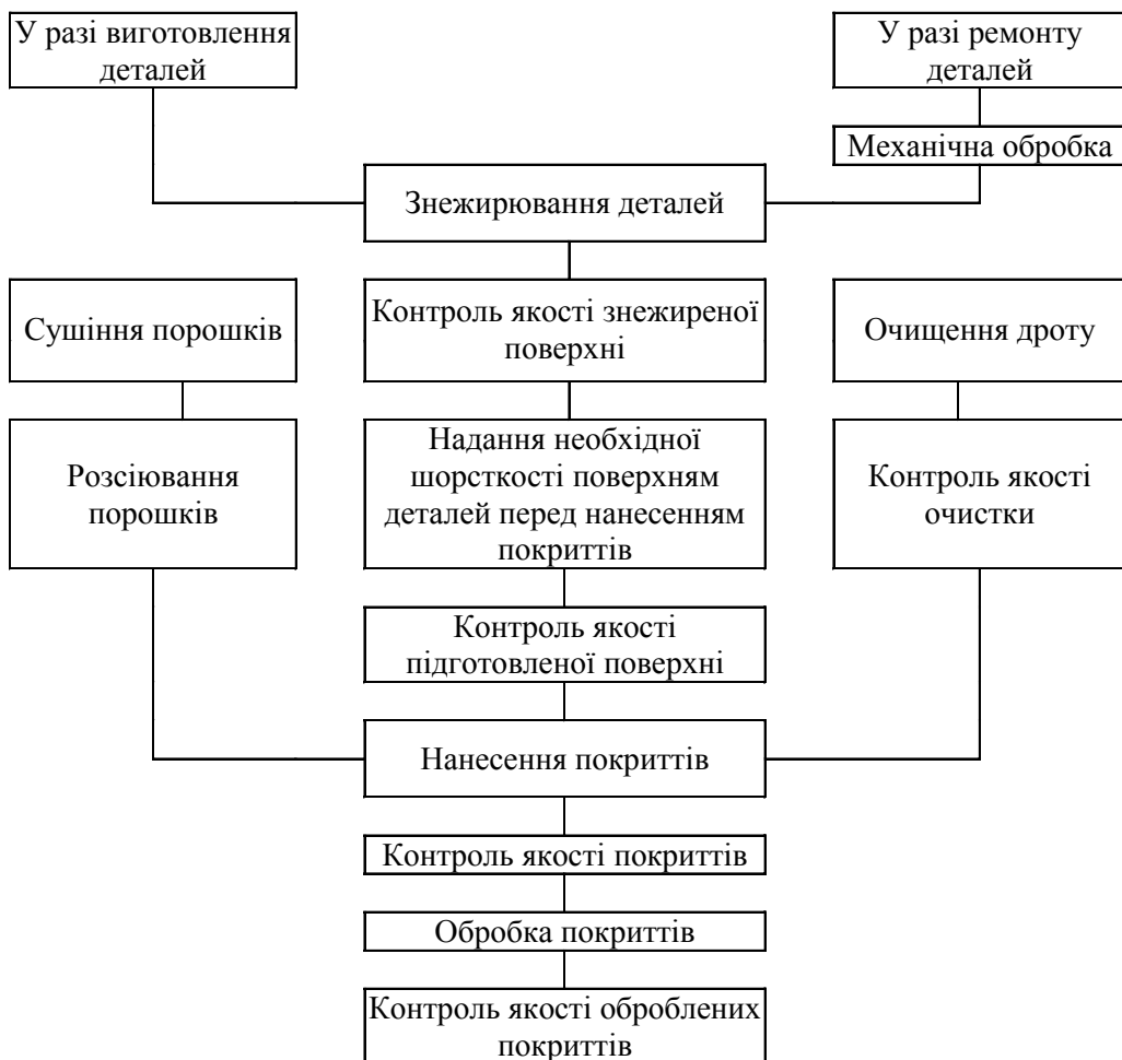
Рис. 6.6. Технологічна схема плазмового напилювання
