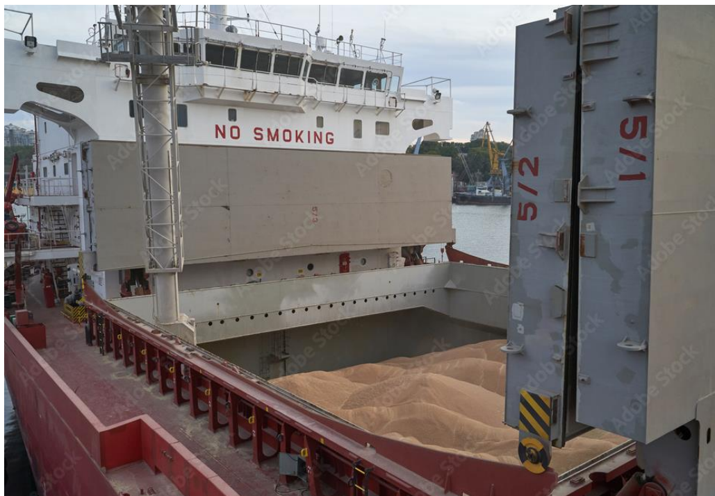
Рис. 1.1. Загальний вид балкера «ABM Justice» і завантаження зерна в трюм балкера з елеваторним краном
