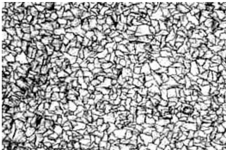
Рисунок 2.4 Мікроструктура ( \times 400 ) срібла марки СрА-1 [6]
