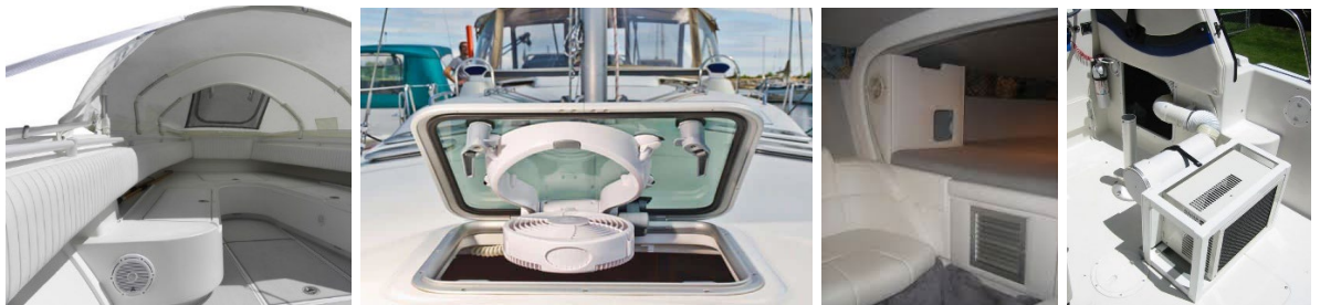
Рис. 7.2-Елементи яхтової вентиляційної системи.
