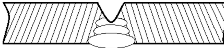
Рисунок 1.7 - Схема зачищення кореня шва
