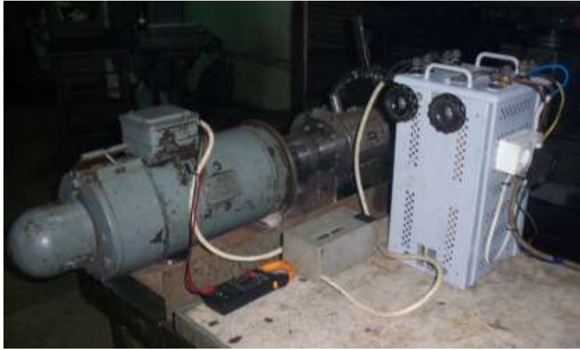
Рисунок 1 – Загальний вигляд експериментального стенда для визначення потужності механічних втрат на базі роторно-поршневого двигуна 12 РПД 4,4/1,75
