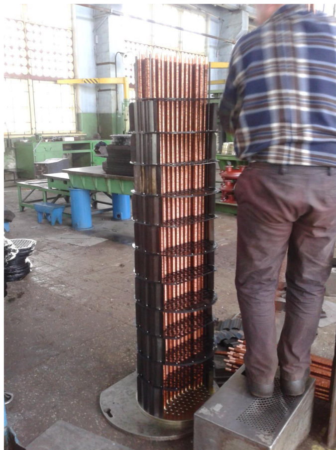
Рис.6.13. Кріплення трубки у трубній дошці методом вальцювання
