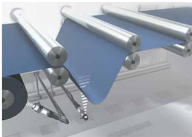
Рис. 2.9. Принцип розташування ультразвукових датчиків відстані типу Balluff BUSM30M1
