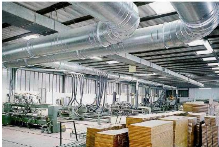
Рис. 4.6. Аспіраційна система деревообробного цеху
