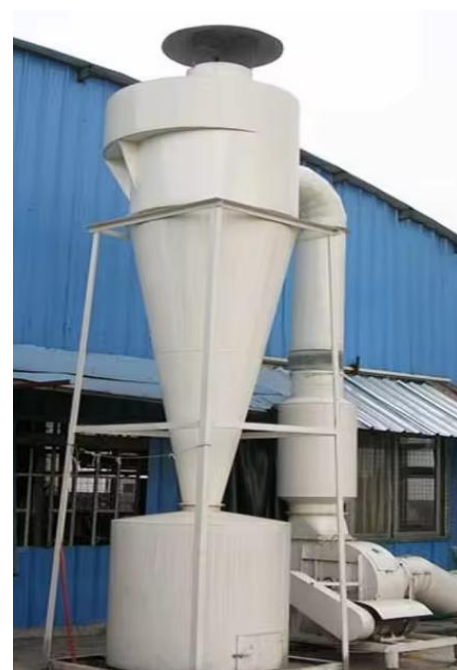
Рис. 4.5. Зовнішній вигляд циклону ЦДО
