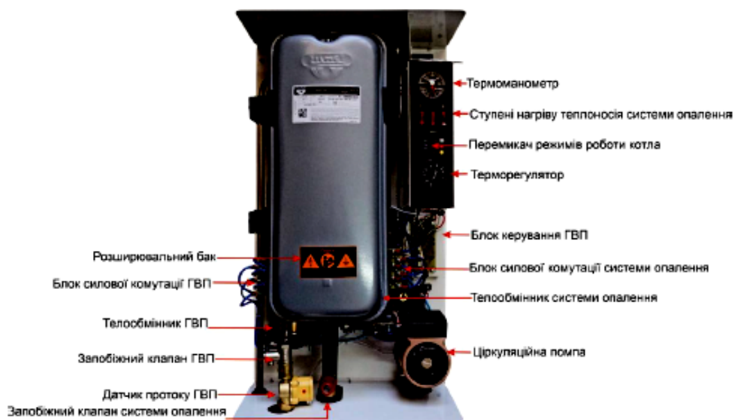
Рис 2.4. Принципова конструкція електричного котла Neon.
