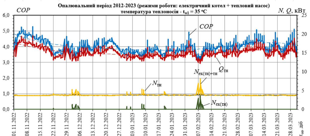
Рис. 4.6. Залежності коефіцієнта COP , навантаження на електричний котел для комбінованої схеми із тепловим насосом N_{EK(TH)} , навантаження на тепловий насос N_{TH} та сумарне навантаження електричного котла та теплового насосу N_{EK(TH)+TH} при температурі теплоносія в системі опалення t_{w1} = 35\text{ }^{\circ}\text{C} .
