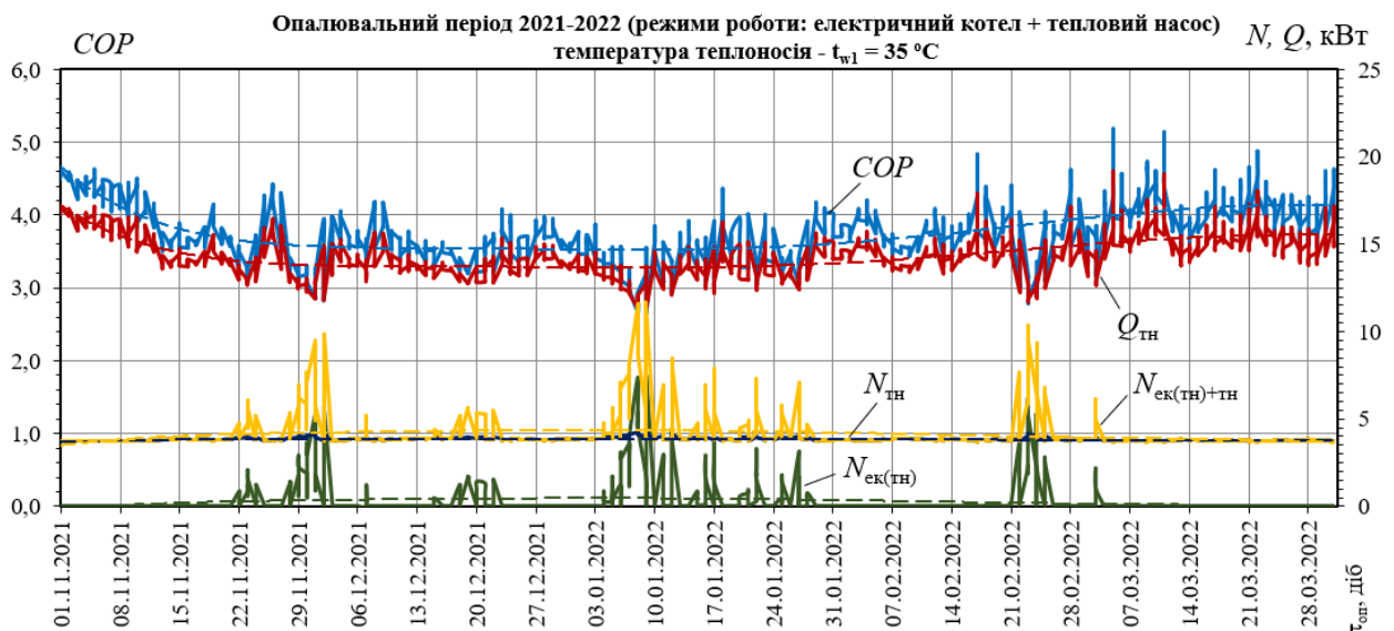
Рис. 4.3. Залежності коефіцієнта COP , навантаження на електричний котел для комбінованої схеми із тепловим насосом N_{\text{ек(тн)}} , навантаження на тепловий насос N_{\text{тн}} та сумарне навантаження електричного котла та теплового насосу N_{\text{ек(тн)+тн}} при температурі теплоносія в системі опалення t_{w1} = 35^\circ\text{C} .
