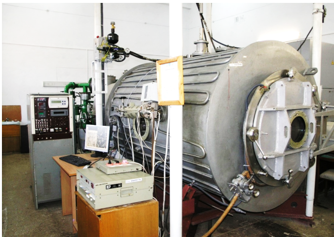
Рис. 2.10 – Загальний вигляд універсальної високовакуумної установки для дифузійного зварювання і паяння
