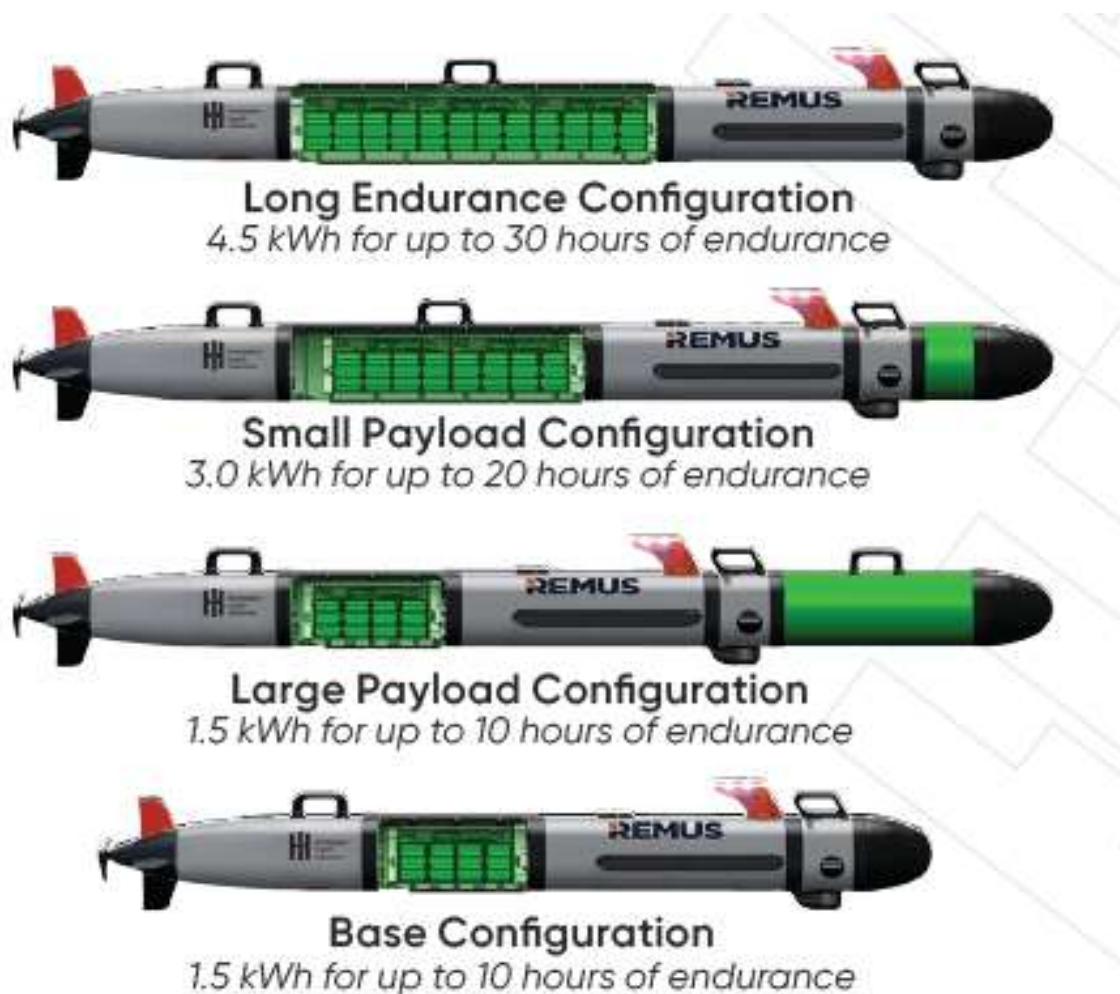
Рисунок 1.1 – Приклад серії АНПА для виявлення вибухонебезпечних підводних об'єктів фірми BlueZone Group (Австралія)
