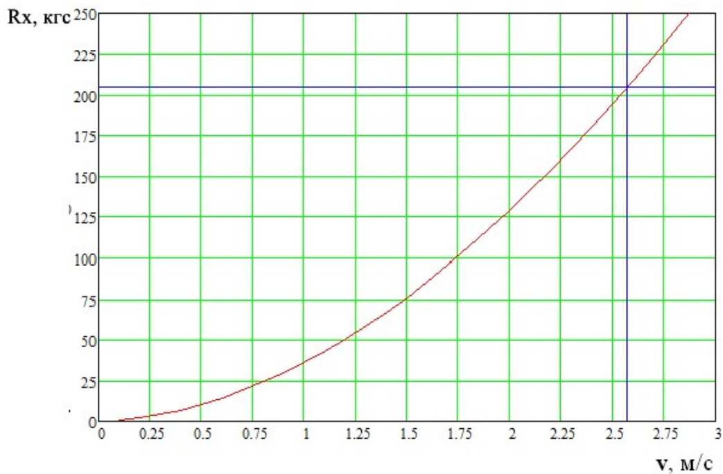
Рисунок 4.1 – Графік залежності бурсирувального опору апарата R_x від швидкості v
