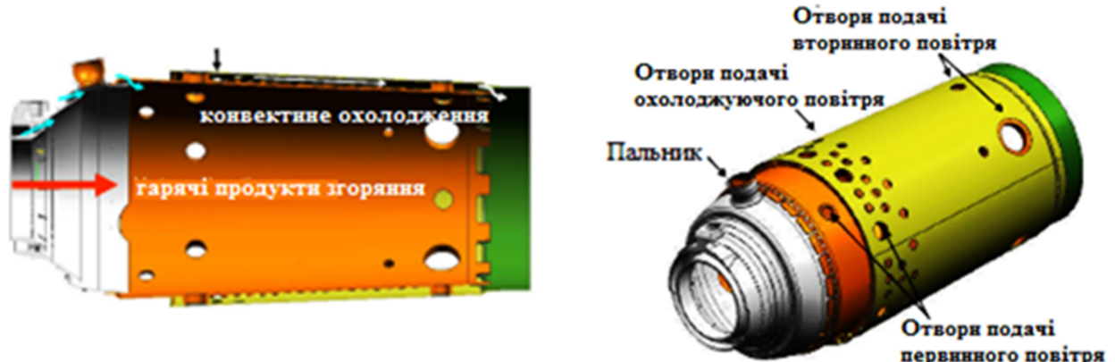
Рис. 4.24. Модифікована низькоемісійна камера згоряння FT8 виробництва компанії Pratt & Whitney
