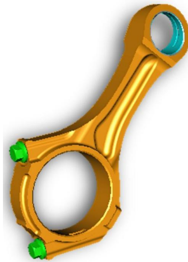
Рисунок 1.5 – Шатунна група дизельного двигуна General Motors 6.6L V8 Duramax серії LML (8ЧН 10,3/9,9)
