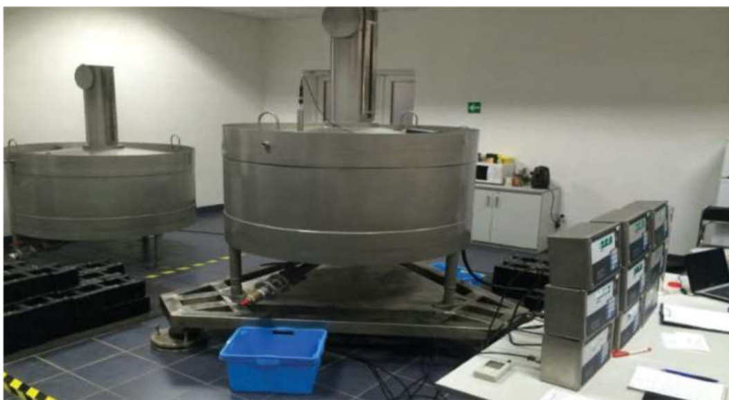
Рис. 2.2 – Визначення місткості мірника на вагах ВСПМ-1500
