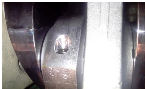
Рис. 4. Вигляд щоки колінчатого валу двигуна Jenbacher 420 після поломки
