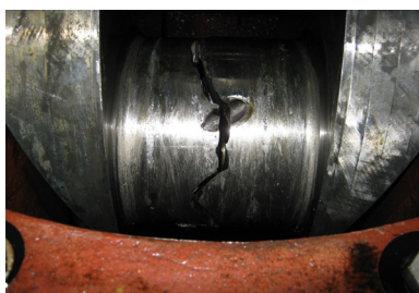
Рис. 1. Вигляд шатунної шийки колінчатого валу двигуна типу ГЧН 25/34 після поломки
