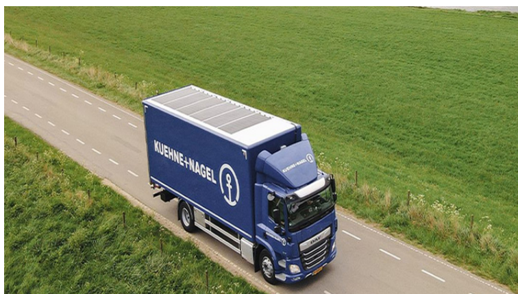
Рис. 1. Автомобілі компанії Kuehne+Nagel з сонячними панелями на даху
