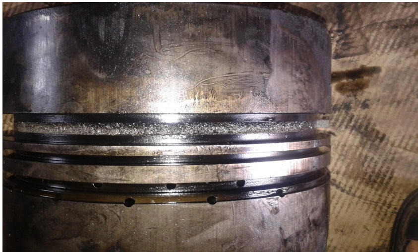
Рис. 8 Руйнування перемички між канавками під поршневі кільця
