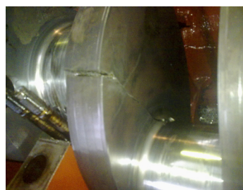
Рис. 2. Вигляд щоки колінчатого валу двигуна типу ГЧН 25/34 після поломки
