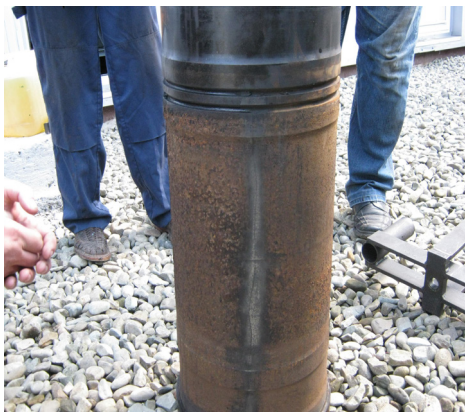
Рис. 5. Руйнування втулки робочого циліндру двигуна 6ГЧН 25/34
