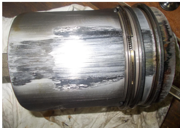
Рис. 6. Задир поршня двигуна Jenbacher 420
