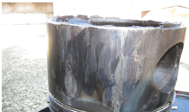
Рис. 7. Обрив тронка поршня
