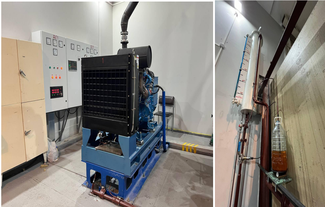
Рис. 2. Загальний вигляд випробувального стенду (праворуч вказана підсистема вимірювання витрати палива)
