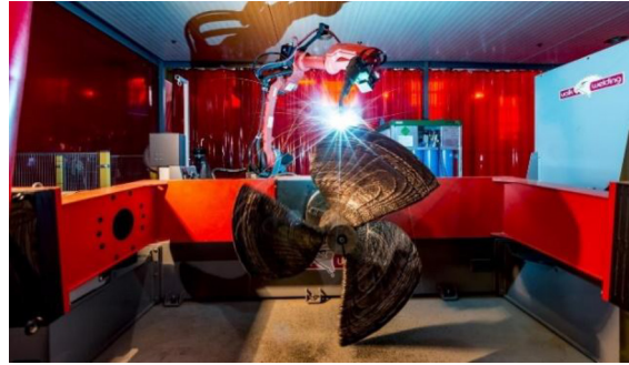
Рис. 1. Процес друку гребного гвинта
