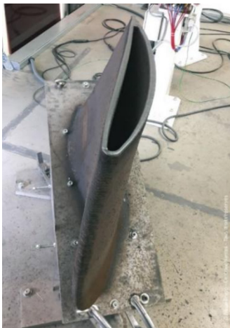
Рис. 6. Дослідний зразок порожнистої лопаті
