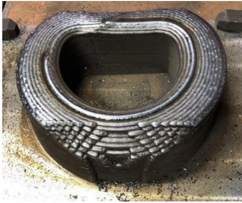
Рис. 3. Процес друку гака
