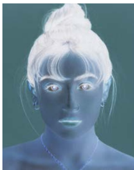
Рис. 5. Приклад накладення AdjustCurvesFilter для ефекту інвертування (час виконання = 0.0238 секунди, задання параметрів Master кривій масиву [{x: 0, y: 255}, {x: 255, y: 0}]) / Pic. 5. Example of applying AdjustCurvesFilter for invert effect (execution time = 0.0238 seconds, setting the Master curve array parameters [{x: 0, y: 255}, {x: 255, y: 0}])
