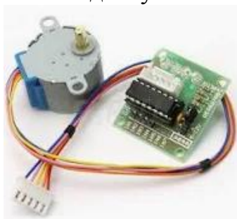
Уніполярний кроковий двигун з платою керування ULN2003
